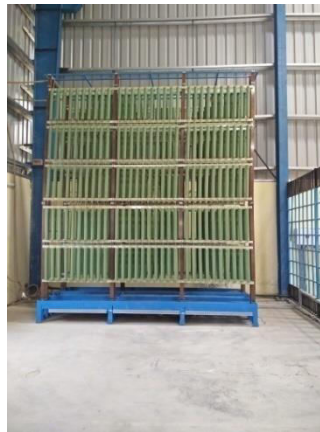
HV LOAD BANK
